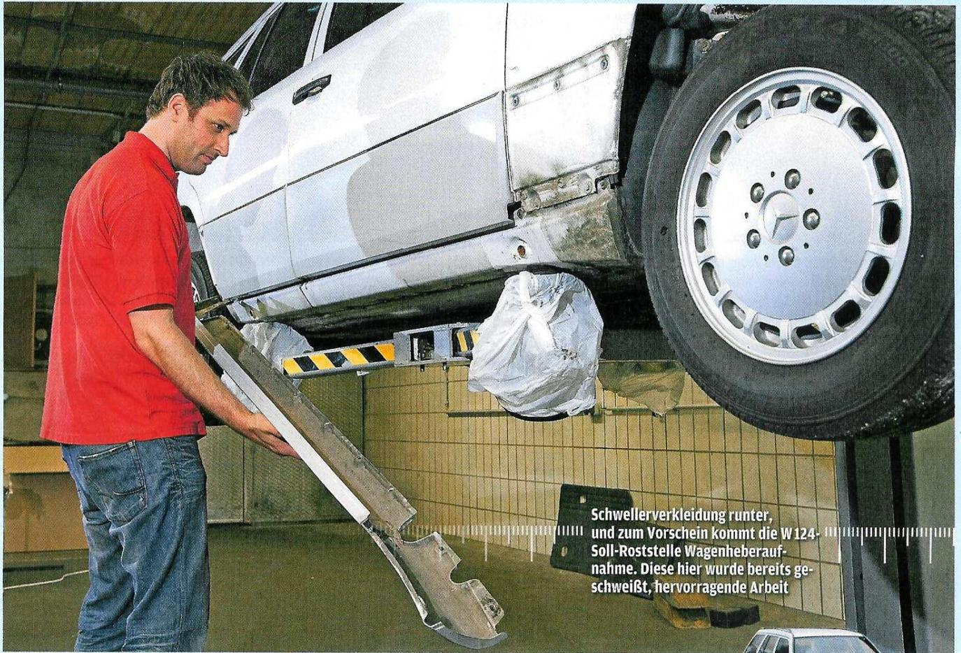
Schwellerverkleidung runter, und zum Vorschein kommt die W 124-Soll-Roststelle Wagenheberaufnahme. Diese hier wurde bereits geschweißt, hervorragende Arbeit
